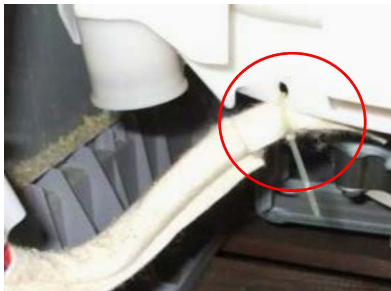
[③水槽部に結束バンドで固定]
